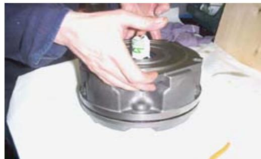
Girare il motore così che l'albero punti verso il basso, inserire e stringere le viti di chiusura del corpo motore. Usando una leva adatta inserita nel foro del perno di trascinamento del distributore, assicurarsi che l'albero ruoti di 360 gradi senza resistenza.
